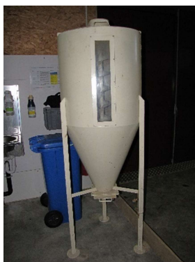
Abbildung 1, Abbildung 2: Futtermischer für Starterfutter mit Schnecke
