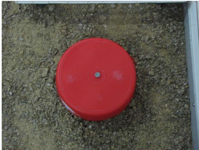
Abbildung 7: Ammoniakmessung im Abteil mit einem umgedrehten Kübel und das Loch mit einem grauen Zapfen zugeschlossen
