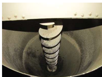
Abbildung 1, Abbildung 2: Futtermischer für Starterfutter mit Schnecke
